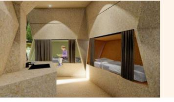
Oculus wurde als modulare Struktur auf der Grundform des Sechsecks entwickelt. Vorgefertigte 6-Eckmodule werden als Schlafzimmer-, Badezimmer- oder Wohnmodule getrennt geplant, ausgeführt und zur Baustelle transportiert.
